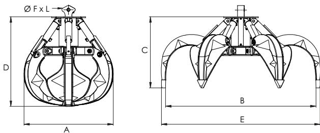
Benna a polipo a cilindri verticali per rottami, rifiuti e materiali vari, per gru da camion.
