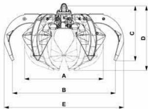
Benna a polipo a cilindri orizzontali per escavatore.
